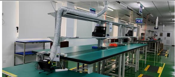
图 7 移动式焊接烟尘净化器
